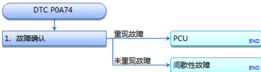
**DTC P0A74:** 发电机电机 V 相电流传感器电路电压过高
